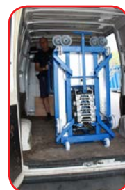
Sistema di carico su automezzo con slitta e barra di ribaltamento
