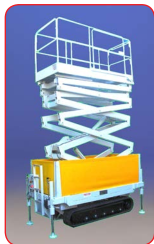
Versione Cingolata da cantiere con stabilizzatori idraulici
