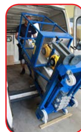
Sistema di carico su automezzo con slitta e barra di ribaltamento
